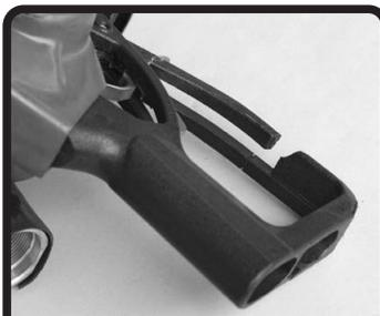
レバー枠が損傷しているとノズルレバーの作動が悪くなる恐れがあります
