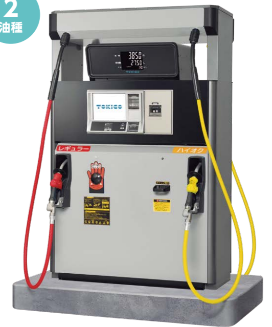
セルフサービス向け GA24N 4 ノズル 3m ホース長 2 表示器 *カラーホースはオプションとなります。
