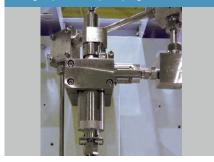
万が一、強い力がホースにかかると離脱。ホースの破損やディスペンサーの転倒を防ぎます。
