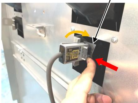
③ノズルレバーを押しながら、ノズルスイッチを矢印の方向に取り付ける
