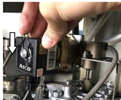
⑤ 給油後、コイルを電磁弁に戻し、
