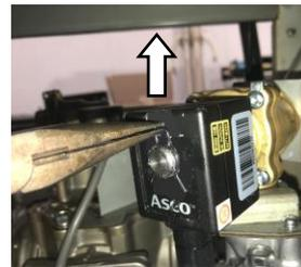
① クリップを工具(ラジオペンチ等)で引き上げる
