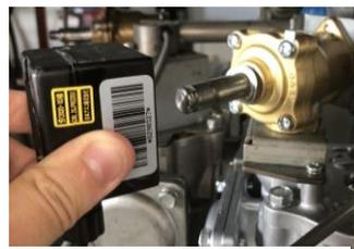
② コイルを電磁弁から取外す
